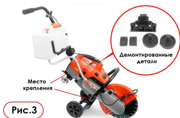
2. Установите резчик на тележку так, чтобы кронштейн снятых колес оказался между зажимной пластиной и рамой тележки, закрутите зажимные болты. (Рис. 4)
