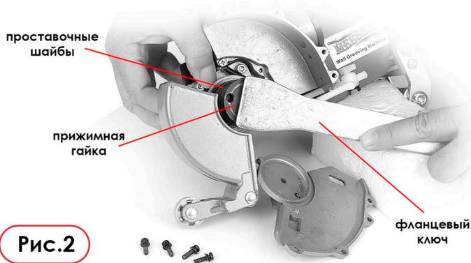
5. Первый алмазный диск установите непосредственно после шайбы на выходной вал, затем установите проставочную шайбу, а затем следующий пильный диск. Повторите указанную операцию до получения требуемой ширины штробы. (Рис. 3) Затем установите соответствующее количество проставочных шайб (убедитесь, что прижимная гайка плотно сжимает пильные диски), и, наконец, верните снятый сегмент защитного кожуха на место, закрепив его винтами.
